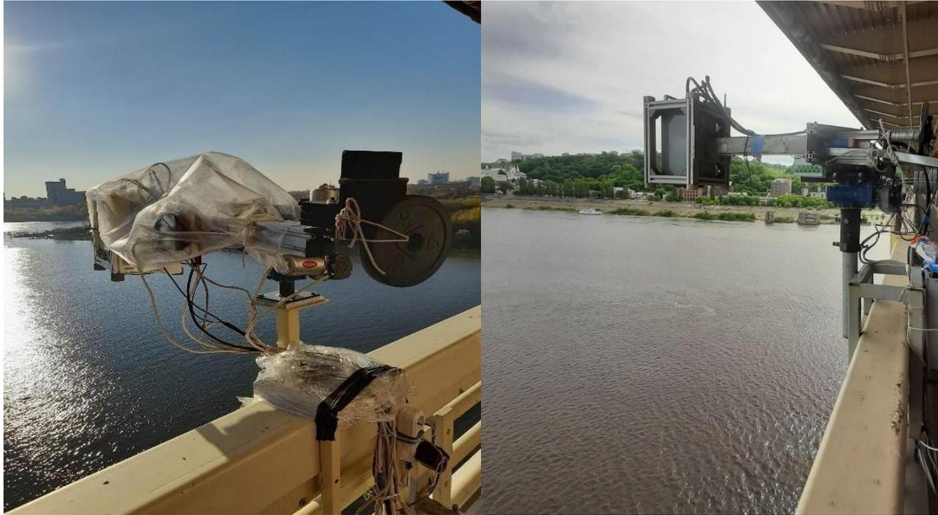
Рис. 2. Радиолокатор №1 (слева) зондирующий против течения и радиолокатор 2 (справа) зондирует по течению.
